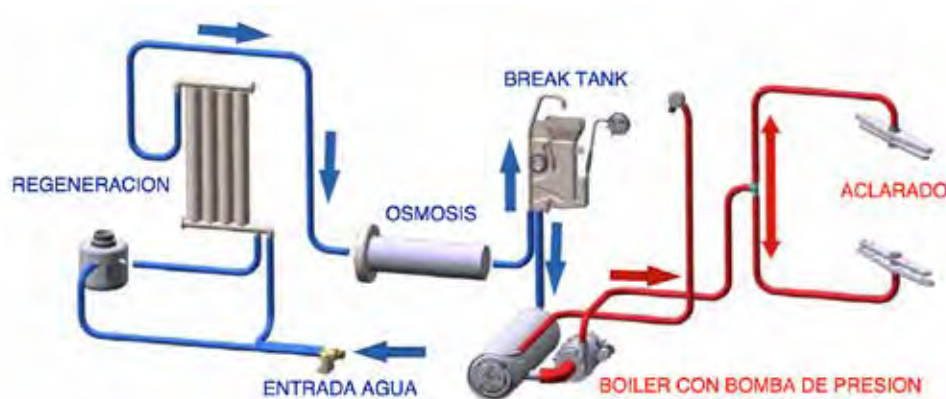
Esquema de funcionamiento N-50 EVO HY-NRG-OSMO
